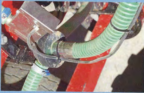
Die elektrische Fahrgassenschaltung ist optional. Dabei schließt sich eine Öffnung des Verteilers. Die restliche Menge wird auf die beiden restlichen Ausläufe verteilt.
