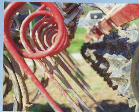
Das Saatrohr hinter dem Zinken legt das Korn direkt auf die wasserführende Bodenschicht ab. Als Nachläufer dient ein Striegel, der die Saatrille zudeckt, und eine einfache Prismenwalze aus Kunststoff, die direkt in der Saatrille läuft und die Saat nochmals andrückt.
