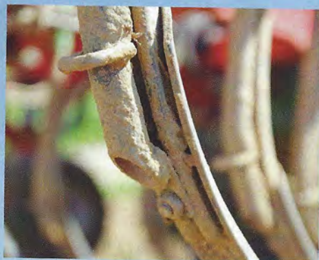
Das Saatrohr hinter dem Zinken legt das Korn direkt auf die wasserführende Bodenschicht ab. Als Nachläufer dient ein Striegel, der die Saatrille zudeckt, und eine einfache Prismenwalze aus Kunststoff, die direkt in der Saatrille läuft und die Saat nochmals andrückt.
