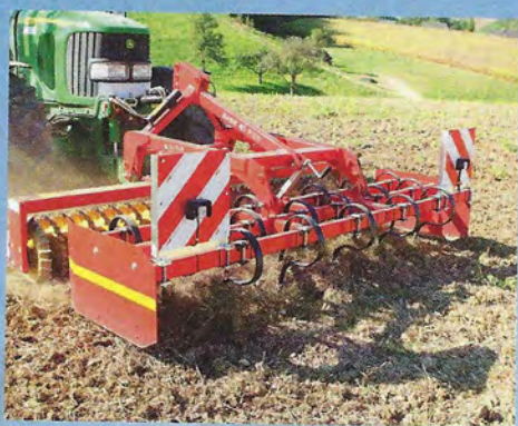
Ein Vorsatzgerät lockert den Boden und zerdrückt größere Erdbrocken.
